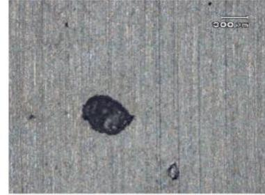
Gambar 3. 1 Cacat Porositas Pada Arm Suspension
